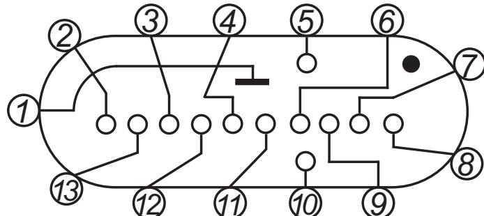
Счет выводов ведется по часовой стрелке от первого вывода, который указан индикаторной стрелкой. Обозначение вывода дано при рассмотрении индикатора со стороны ножки.
